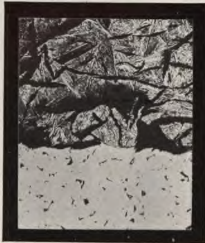
Fig. 150. Oberer Teil: Graues Roheisen. Unterer Teil: Reines Flußeisen mit wenig Perlit.
